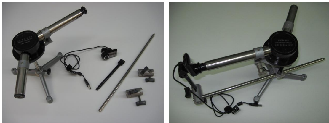
Slika 2: S stativnim materialom (levo) pritrdimo spletno kamero na spektroskop (desno).
