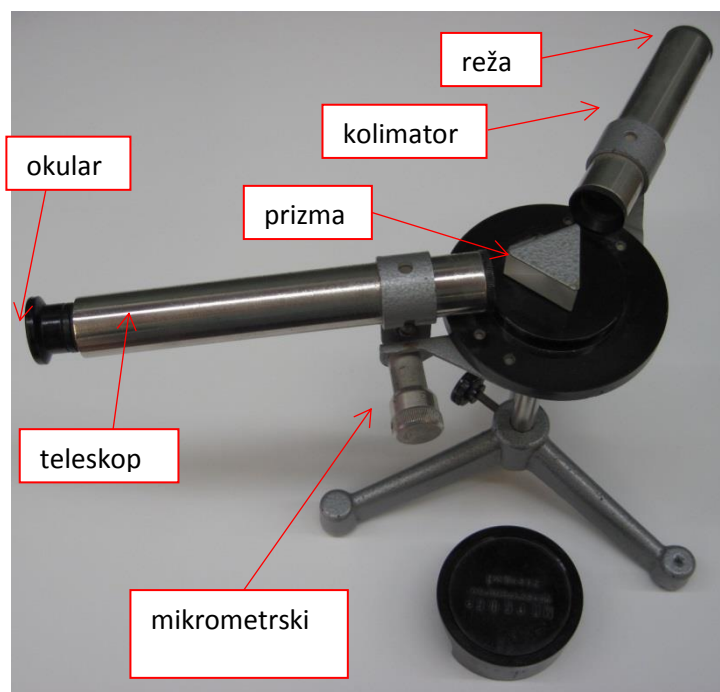
Slika 1: Zgradba optičnega spektroskopa na prizmo.
