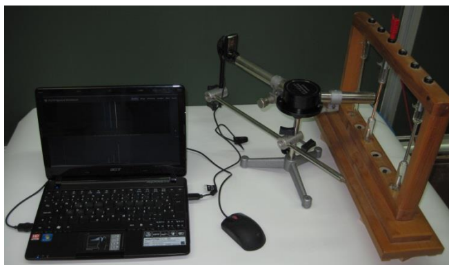
Slika 6: Merjenje emisijskih spektrov plinov z uporabo IKT.
